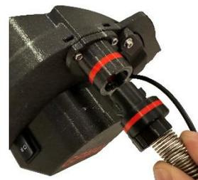
Posizionare il Bullet Feeder in modo che la molla non sia troppo in tensione e, nello stesso tempo, non abbia angolazioni dove potrebbero fermarsi le palle in fase di discesa.
