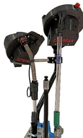
In casi particolari, dove non esistesse un tubo tondo da 25mm o dove un Case Feeder particolarmente ingombrante ne limitasse l'installazione, è disponibile un supporto da banco, codice ARP-BUL-VERT.
