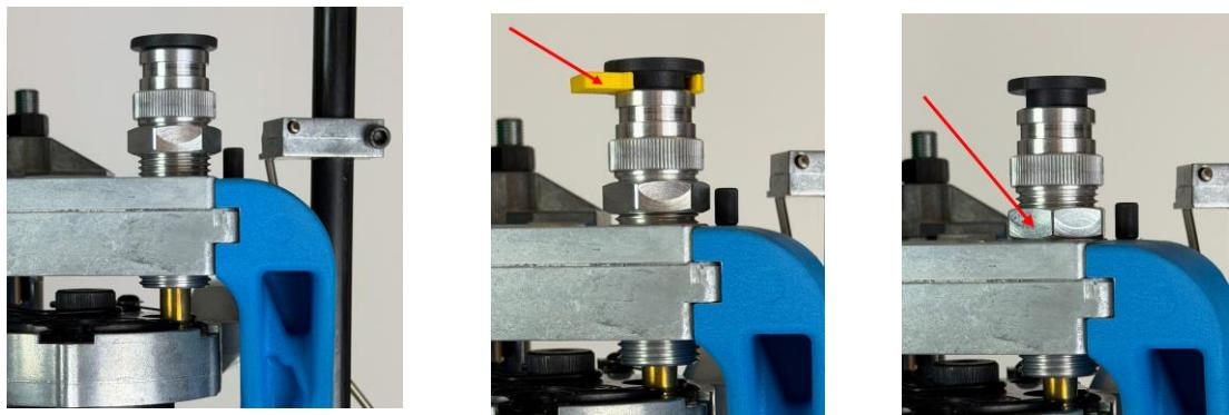
Posizionare un bossolo senza polvere, della dimensione corretta, nello Shell Plate ed azionare la leva della pressa fino a fine corsa.
